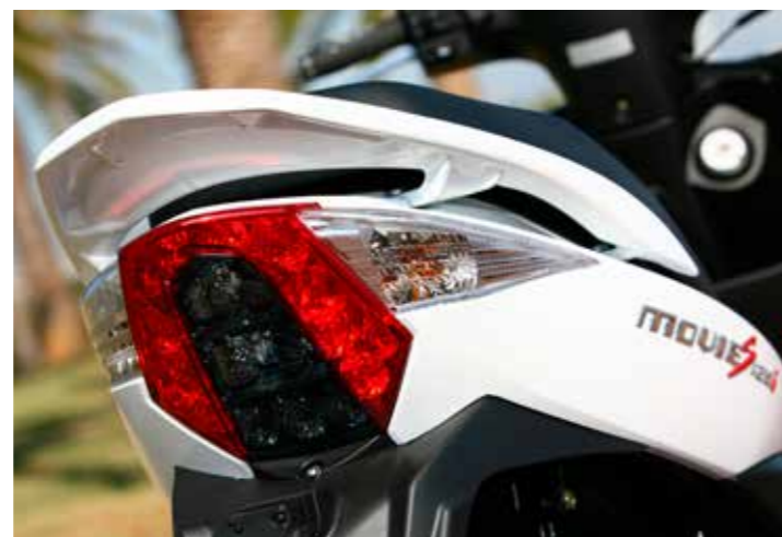
LED achterlicht en richtingaanwijzers met conventionele verlichting
