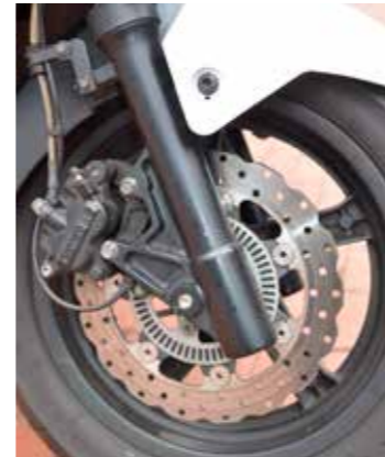
Wave schijf maar geen ABS op ons testexemplaar
